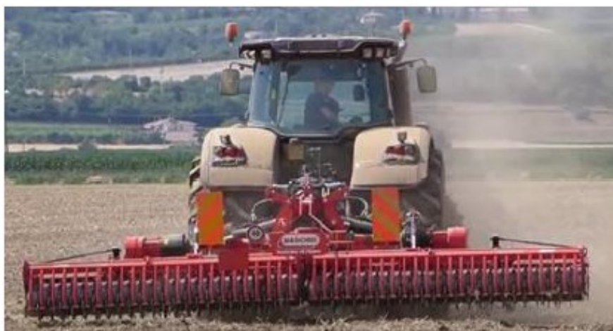
Figura 56: Tipologia di erpice che può essere utilizzato per la coltivazione tra i tracker
